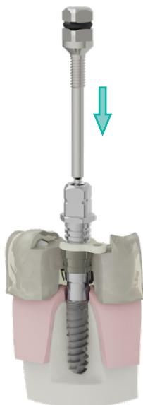
Introducir el extractor dentro del orificio superior del montador.
