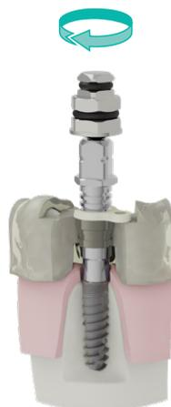
Girar en sentido anti horario hasta que el tornillo se libere del implante.
