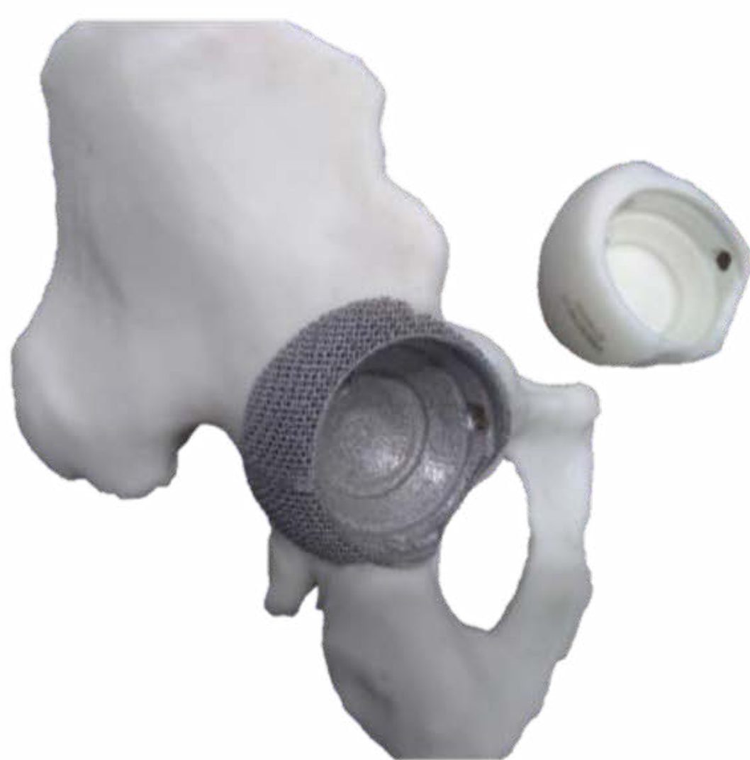
Reconstrucción acetabular con impresión en Titanio Gr 5
